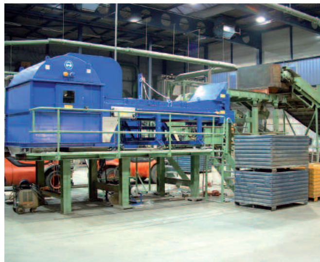
Ein weiterer Meilenstein in Richtung der vollständigen Rückgewinnung von Rohstoffen: die Röntgensortieranlage.
